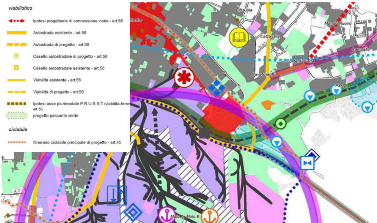
Figura 15 – Estratto Tav. 4-2/3 – PTCP Sistema Insediativo -Infrastrutturale (in giallo area d'intervento). Si vede che il progetto allo studio soddisfa, tramite un tracciato parallelo a quello indicato in PTCP, la stessa domanda di mobilità ciclabile.
